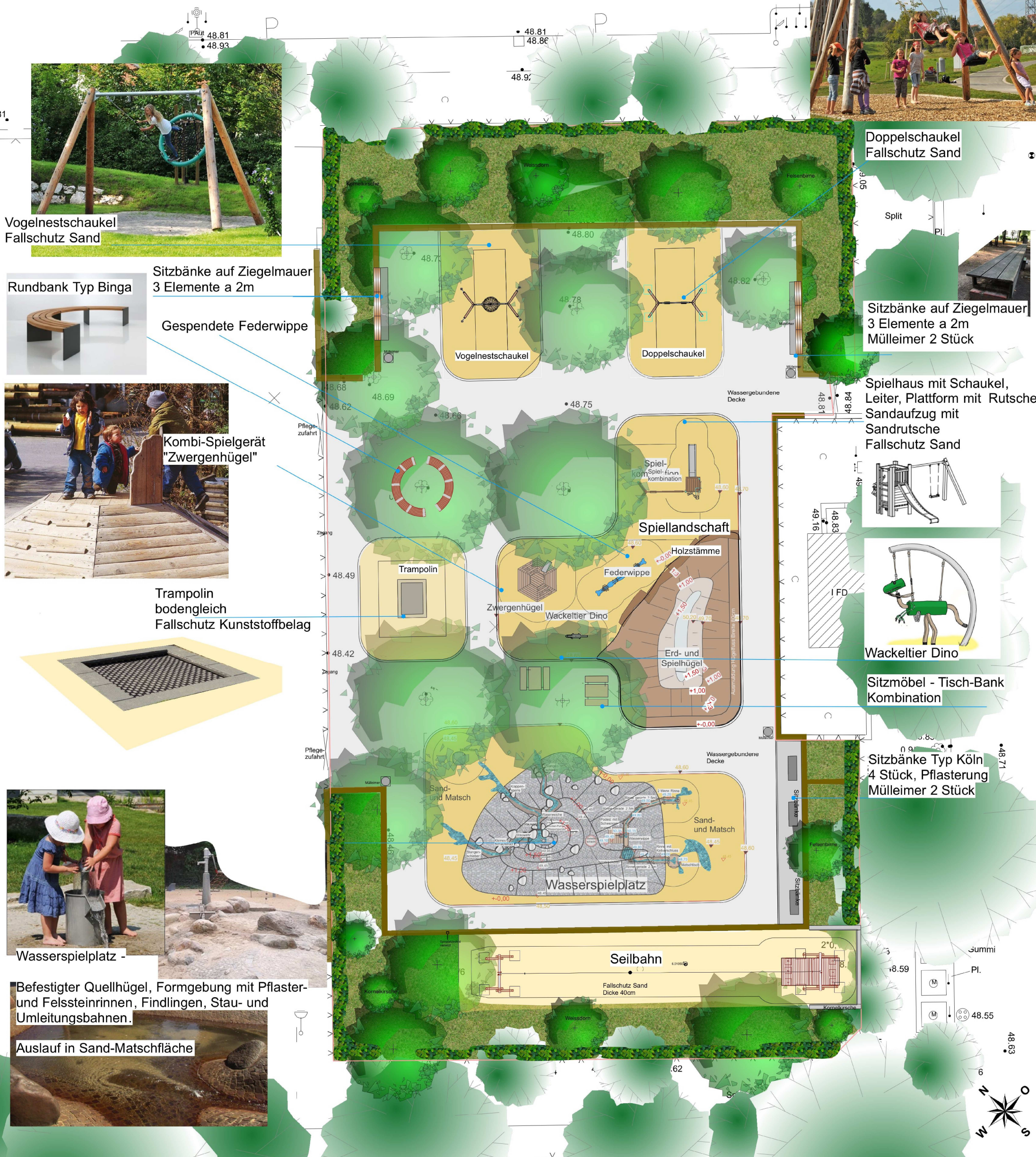
Wasserspielkombination mit Rinnen, Wasserwippe, Staurinnen, Matschtisch. Pumpenpodest ca. 0,95m über Sandfläche im Quellhügel. Auslauf in Sand-Matschfläche-
